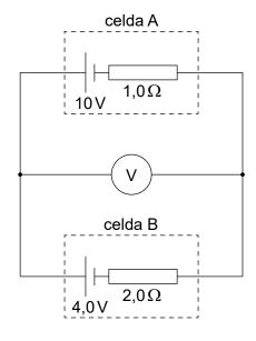
La celda A tiene una f. e. m. de 10 V y una resistencia interna de 1,0  $\Omega$ , mientras que la celda B tiene una f. e. m. de 4,0 V y una resistencia interna de 2,0  $\Omega$ .
