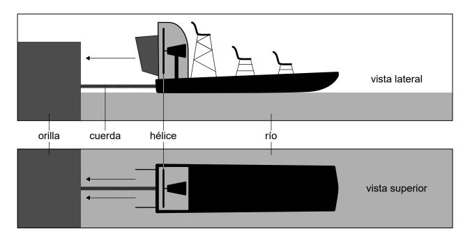
Una aerolancha tiene una hélice con aspa de 1,8 m de radio. Esta hélice puede impulsar el aire con una rapidez máxima respecto a la aerolancha de 20 m s<sup>-1</sup>. La densidad del aire es de  $1,2 \, \text{kg m}^{-3}$ .
